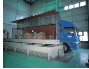
荷受ホッパー 県内各地から届いた原料玄米を荷受するところです。また、フレコン荷受も可能です。
