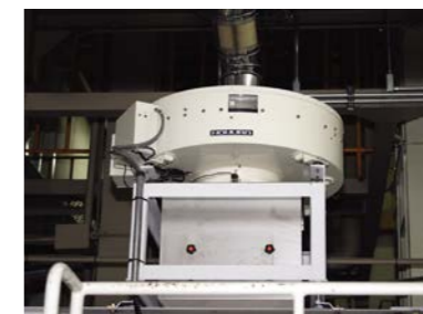
糠玉取機 精米工程で発生する糠のかたまり(糠玉)を選別除去する機械です。
