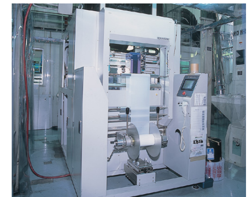
全自動計量包装機 精米を自動的に計量、包装し「秋田米」の誕生となります。
