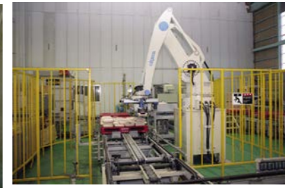
パレタイザー 袋詰めされた「秋田米」を自動的にパレットに積み上げます。
