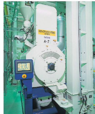
無洗米加工機 熱附着材を利用し、微粉糠を取り除き研がずに炊けるお米無洗米をつくります。
