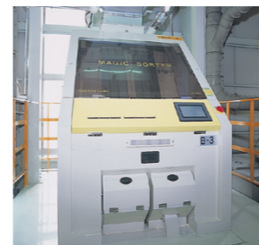
マジックソーター 光センサーによってガラス・プラスチック・着色粒等を取り除きます。
