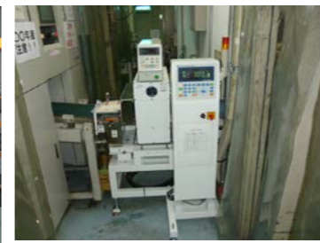
金属検査機・ウェイトチェッカー 精米された米に金属の混入がないかチェックする機械です。また、包装された製品の重量に誤差がないか確認します。
