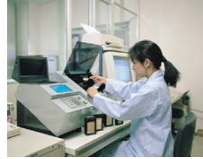
品質・食味分析 原料玄米入荷時にサンプルを採取、また精米の出荷単位ごとに製品サンプルを採取して、品質・食味値を測定し、基準値内であることを確認しております。
