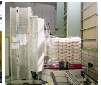
ストレッチャー パレット積みされた製品にフィルムを巻き、汚れ・荷崩れを防ぎます。
