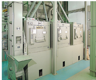
粗選・石抜き 玄米に混入している異物を除去します。小石や金属片などは、比重を利用して取り除きます。
