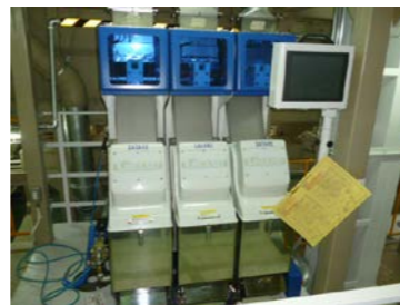
フルカラーカメラ搭載選別機 フルカラーCCDカメラで微かな色合いの差を判別可能。マジックソーターと併用することにより、より確実に異物・着色粒等の除去ができます。
