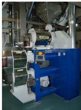
中ロット用高性能精米機 玄米を精米することのできる高性能の精米機です。また、米粒に無理な力を加えず、低温で精米し、食味の良いお米に仕上げます。
