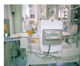
金属検査機 精米された米に金属の混入がないかチェックする機械です。
