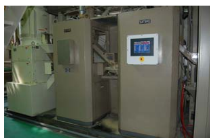
大ロット用高性能精米機 一度に大量の玄米を精米することのできる高性能の精米機です。また、米粒に無理な力を加えず、低温で精米し、食味の良いお米に仕上げます。
