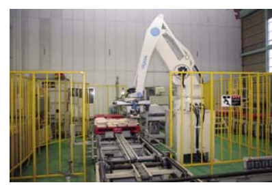
パレタイザー 袋詰めされた「秋田米」を自動的にパレットに積み上げます。
