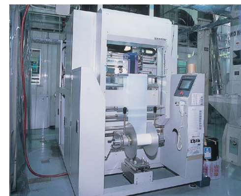
全自動計量包装機 精米を自動的に計量、包装します。
