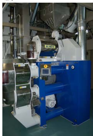
中ロット用高性能精米機 製造ロットに応じた玄米を精米することのできる高性能の精米機です。また、米粒に無理な力を加えず、低温で精米し、食味の良いお米に仕上げます。
