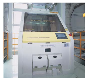
マジックソーター 光センサーによってガラス・プラスチック・着色粒等を取り除きます。
