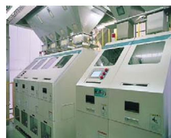
ガラス選別機 コンピューターの眼により、ガラスの排除はもちろんマジックソーターと併用することにより、より確実に異物・着色粒等の除去ができます。
