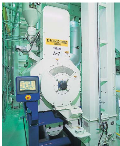
無洗米加工機 タビオカを利用し、微粉糠を取り除き研がずに炊けるお米無洗米をつくります。
