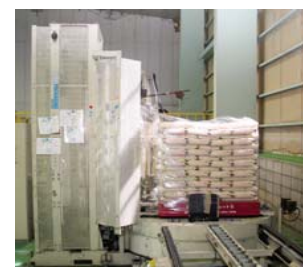
ストレッチャー パレット積みされた製品にフィルムを巻き、汚れ・荷崩れを防ぎます。
